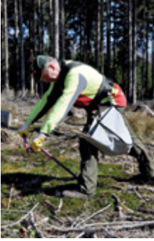
Bild 30a/b: Göttinger Fahrradlenker Blattlänge: 400 mm; Blattbreite: 120 mm; Stiellänge: 1000 mm; Gewicht: 4880 g
