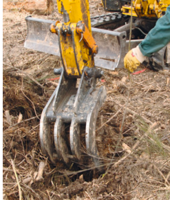
Bild 36: Kombiniertes Pflanzverfahren mit Kleinbagger
