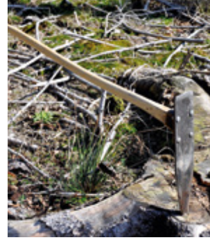
Bild 31a/b: Buchenbühler Schrägpflanzhaue mit Pflanzen-Doppeltragetasche Blattlänge: 425 mm; Blattbreite: 90 mm; Stiellänge: 1000 mm; Gewicht: 3250 g; Winkelstellung Blatt zum Stiel: 100 Grad
