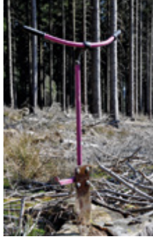
Bild 30a/b: Göttinger Fahrradlenker Blattlänge: 400 mm; Blattbreite: 120 mm; Stiellänge: 1000 mm; Gewicht: 4880 g
