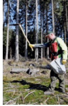
Bild 31a/b: Buchenbühler Schrägpflanzhaue mit Pflanzen-Doppeltragetasche Blattlänge: 425 mm; Blattbreite: 90 mm; Stiellänge: 1000 mm; Gewicht: 3250 g; Winkelstellung Blatt zum Stiel: 100 Grad
