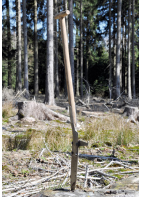
Bild 29a: Pflanzspaten Neheim (FBZ); Blattlänge: 415 mm; Blattbreite: 98 mm; Länge (mit Blatt): 1225 mm; Gewicht: 3080 g; Winkelstellung Blatt zum Stiel: 11 Grad
